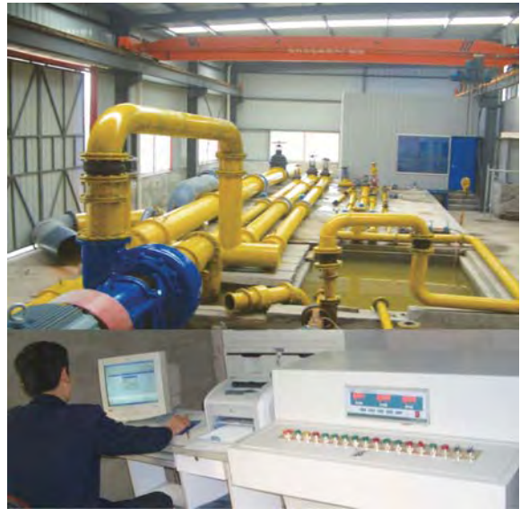
▲ 8000m 3 /h泵全性能测试台
