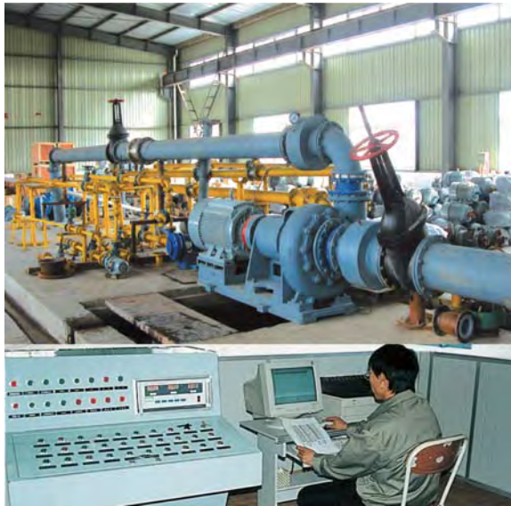
▲ 2000m 3 /h泵全性能测试台
