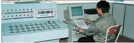
▲ 2000m 3 /h泵全性能测试台
