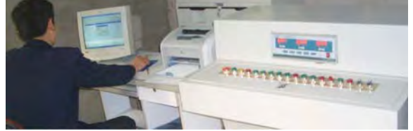
▲ 8000m 3 /h泵全性能测试台
