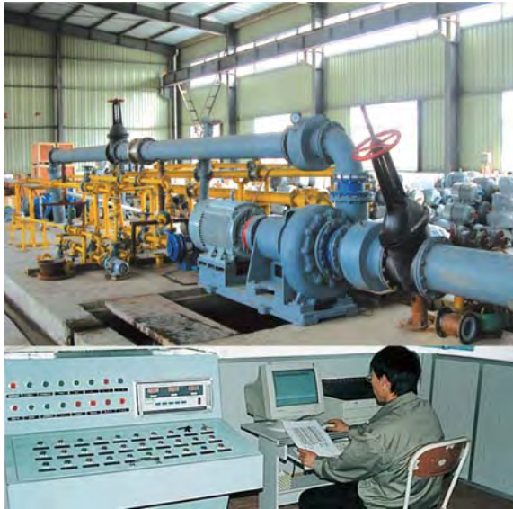
▲ 2000m 3 /h泵全性能测试台
