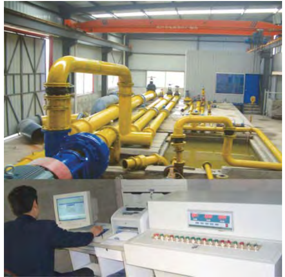
▲ 8000m 3 /h泵全性能测试台
